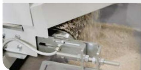
Qui dit fraisage dit copeaux ! Raison pour laquelle il existe une bande convoyeuse de copeaux à faible encombrement intégrée au bâti de machine. Elle permet également d'acheminer avec fiabilité de gros volumes de copeaux jusqu'à l'aspiration.
