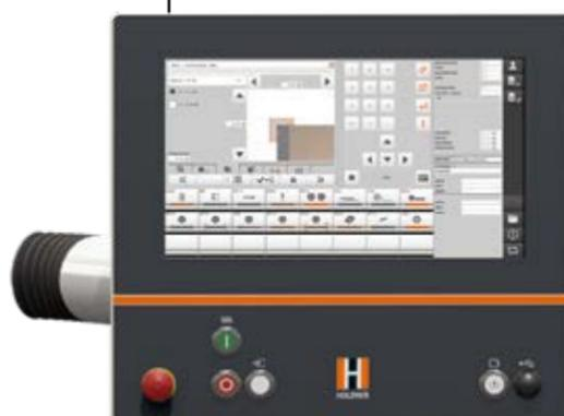
L'opérateur peut à tout moment détecter graphiquement ce qui doit être corrigé et dans quel sens. Les valeurs saisies sur le tableau de commande sont recalculées de manière entièrement automatique en arrière-plan suivant les valeurs axiales réelles. Autrement dit, plus besoin de réaliser des prototypes.
