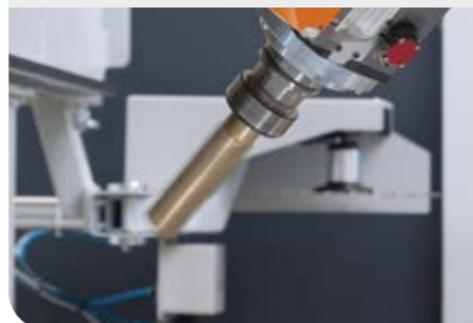
Grâce à la technologie Bluetooth, toutes les données contrôlées (vibrations, température du palier ou vitesse de rotation) sont transmises à l'application viaCockpit. Tout dépassement des paramètres de sécurité déclenche une alarme sur l'écran de la machine et apparaît sur ViaCondition ou viaCockpit.
